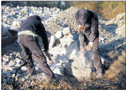
Der Gipsstein wird gebrochen
